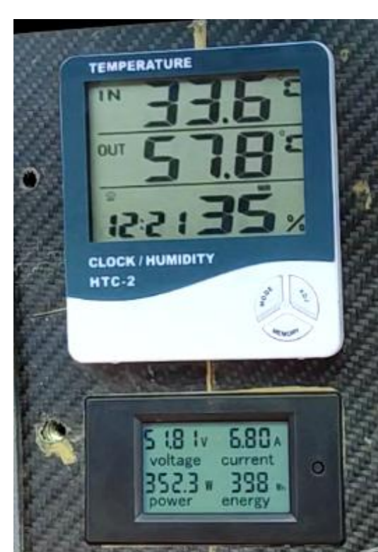
ภาพแสดงผลด้านซ้าย ขณะไม่ฉีดน้ำ อุณหภูมิแผงโซลาร์เซลล์ 57.8 องศาเซลเซียส กระแสอยู่ที่ 6.8 แอมป์
