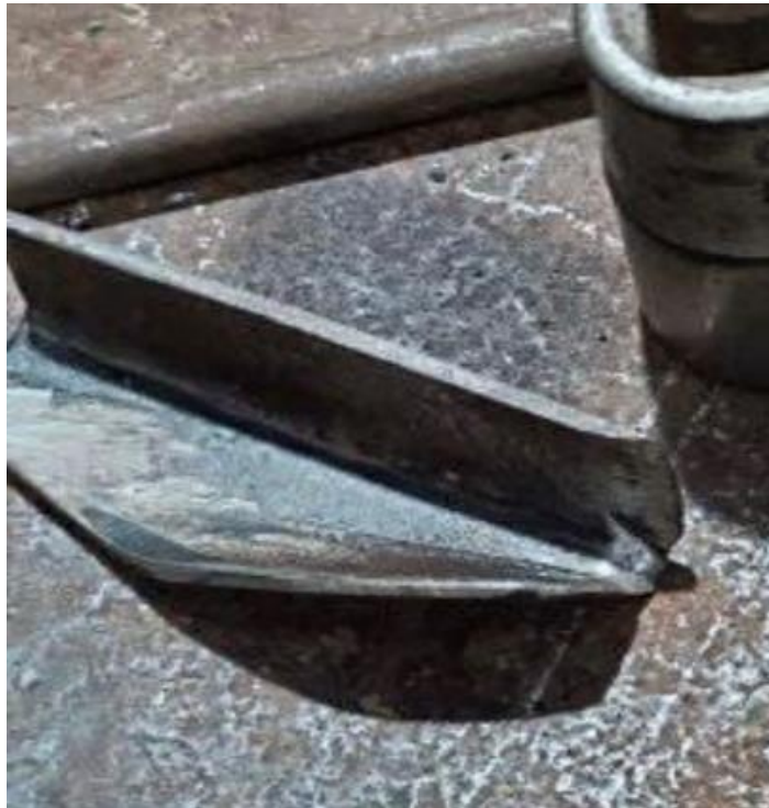
ตัดเหล็กแผ่นให้เป็นรูปทรงสามเหลี่ยม
