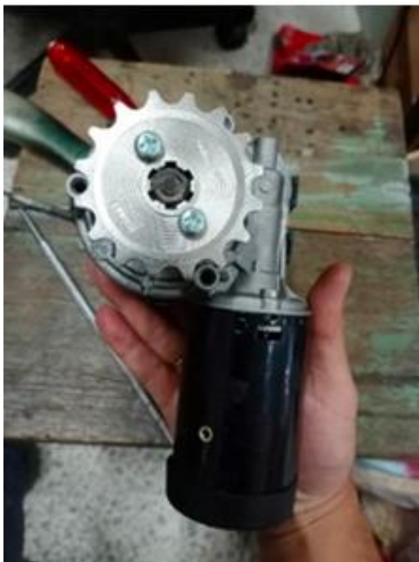
การประกอบเฟืองเกียร์แกนมอเตอร์ไฟฟ้า
