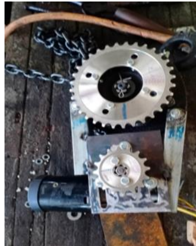
การติดตั้งมอเตอร์ไฟฟ้า
